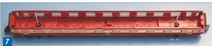
Nach der Montage der Stromabnehmer werden die Räder eingesetzt (Bild 8).
