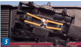
Die beiden Kontaktfedern «KF1» sind nach oben gebogen (Bild 6) und nur diese liegen an den Achsen an (Bild 8). Die Kontaktfedern «KF2» werden nur nach oben gebogen, wenn die Kontaktfedern «KF1» abgenutzt sind. Es dürfen nur 2 Kontaktfedern pro Drehgestell an den Achsen anliegen, sonst wird der Wagen zu stark gebremst!
