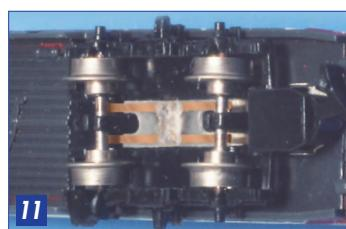
**Wichtig:** Die Kontaktfedern «KF1» der Stromabnehmer (Bild 11) müssen an den Achsen anliegen. Kontaktfedern wenn nötig leicht nachbiegen – beim Nachbiegen darauf achten dass die Federkraft den Wagen nicht zu stark bremst.
