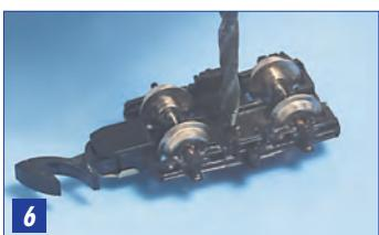
Loch an der Drehgestell-Unterseite mit einem 2mm ø Bohrer entgraten (Bild 6).
