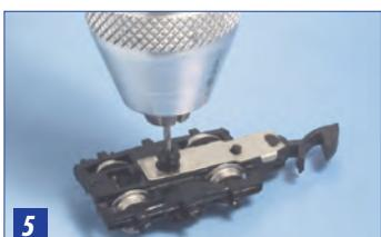
In jeden der beiden Drehgestellzapfen ein Loch mit 0,8mm ø bohren (Bild 5).
