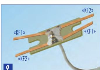
Die Kontaktfedern «KF1» sind nach oben gebogen (Bild 9) und liegen an den Achsen an (Bild 11). Die Kontaktfedern «KF2» werden nur nach oben gebogen, wenn die Kontaktfedern «KF1» abgenutzt sind. Es dürfen nur 2 Kontaktfedern pro Drehgestell an den Achsen anliegen, sonst wird der Wagen zu stark gebremst.
