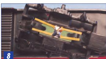
Stromabnehmer in die Vertiefung des Drehgestells einsetzen, zentrieren und andrücken. (Bild 8). Die Kontaktfedern dürfen die Achshalterungen seitlich nicht berühren.
