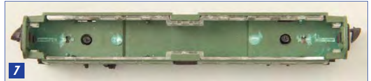
Bild 7 zeigt den für den Einbau der Wagenbeleuchtung vorbereiteten Wagen-Innenraum.
