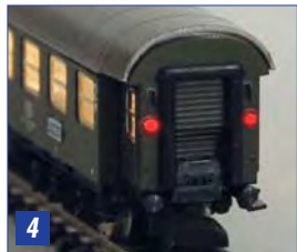
Bilder 3 und 4 zeigen den mini-club Personenwagen 8754 , bestückt mit der mobatron Wagenbeleuchtung WBL-Z-L-5WW-2R .
