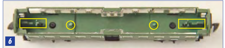
Bild 7 zeigt den für den Einbau der Wagenbeleuchtung vorbereiteten Wagen-Innenraum.
