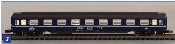
Bilder 3 und 4 zeigen den mini-club Personenwagen 8742, bestückt mit der mobatron Wagenbeleuchtung WBLD-Z-Q-6WW-2R .
