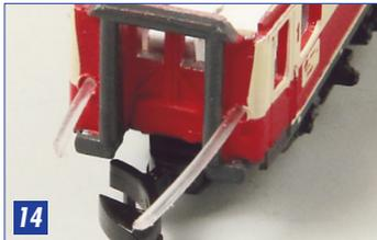
Die nach aussen ragenden Lichtleiter (Bild 14) mit einem Seitenschneider abschneiden. Eine saubere Schnittfläche der Lichtleiter ergibt einen besseren Lichtaustritt!
