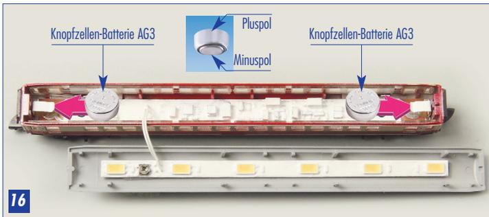
Bild 17 zeigt die Wagenbeleuchtung mit eingesetzten Knopfzellen-Batterien.
