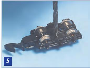
Loch an der Drehgestell-Unterseite mit einem 2 mm  $\varnothing$  Bohrer entgraten (Bild 5).
