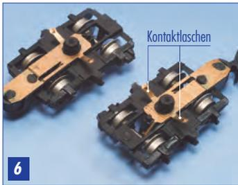
Kontaktaschen (Bild 6) an beiden Drehgestellen gemäss Bild 7 auf einer Seite kürzen und auf der andern Seite wegschneiden.
