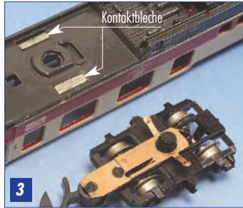
In jeden der beiden Drehgestellzapfen ein Loch mit 0,8 mm  $\varnothing$  bohren (Bild 4).
