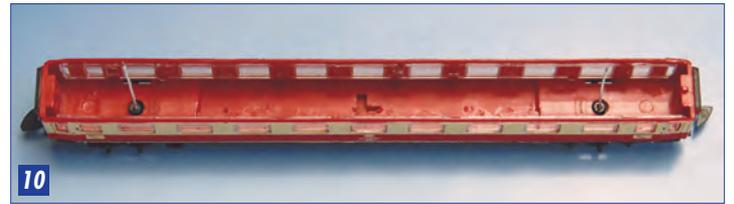
Bild 11 zeigt einen Wagen, in dem die mobatron Wagenbeleuchtung WBL-Z-A-6WW-2R eingebaut ist.
