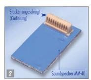
Die Geräusche, Ansagen, usw., sind auf dem blauen steckbaren Soundspeicher MM-40 gespeichert (Bild 1 und 2).
